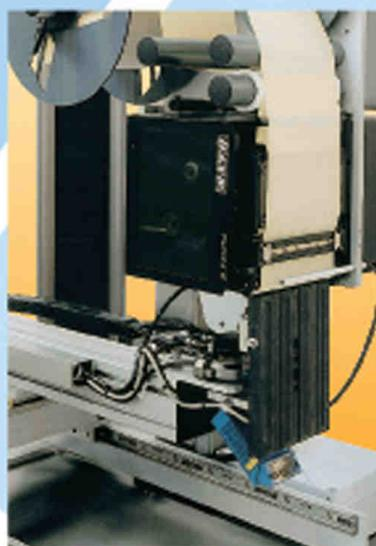
su un sistema di movimentazione a 3 assi, con guide a sfere che permettono un veloce e preciso posizionamento delle etichette anche su pallet di dimensioni, forme e posizioni di arresto leggermente differenti.
