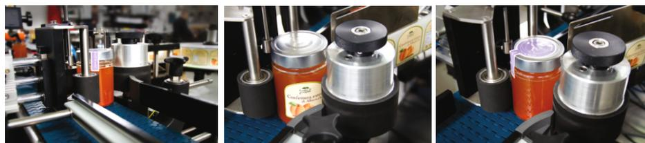
**IT** Possibilita' di orientamento dell'etichetta/e di corpo tramite riconoscimento sigillo di garanzia, banda stagna o tramite lettura riferimento presente sul prodotto (codice a barre, logo o altro) Sistema/i di etichettatura (da h eticheta max 50-100-140-190mm) e nastro trasportatore motorizzato sono montati su basamento in acciaio inox.
