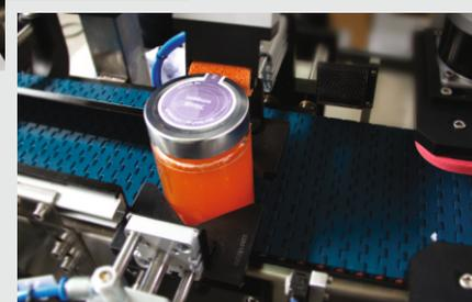
**IT** Interfaccia operatore tramite touch screen multicolor e sincronizzazione fasi di etichettatura tramite p.l.c., memoria disponibile di oltre 40 formanti (estendibile) sistema include un spaziatore prodotti per cadenziare correttamente i prodotti prima della fase di etichettatura, accessori disponibili: gruppo stampa per lotto e/o scadenza, piatto di carico o scarico, copertura anti-infortunistica
