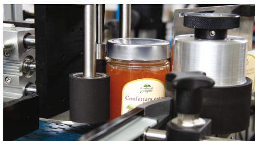
**IT** Etichettatrice lineare per applicazione di etichette di corpo avvolgente o semi-avvolgente e sigillo di garanzia per contenitori cilindrici, troco-conici e esagonali in vetro, alluminio e plastica
