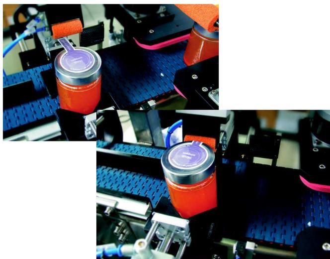
Possibilità di orientamento dell'etichetta/e di corpo tramite riconoscimento sigillo di garanzia, banda stagna o tramite lettura riferimento presente sul prodotto (codice a barre, logo o altro). Sistema/i di etichettatura (da h etichetta max 50 100 - 140 - 190 mm) e nastro trasportatore motorizzato sono montati su basamento in acciaio inox.
