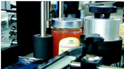
Etichettatrice lineare per applicazione di etichette di corpo avvolgente o semi-avvolgente e sigillo di garanzia per contenitori cilindrici, tronco-conici e esagonali in vetro, alluminio e plastica.
