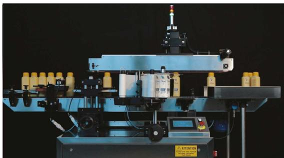
Linea di etichettatura con nastro trasportatore a velocità variabile. Monoblocco in acciaio inox. Disponibile con 2 teste di etichettatura da 100 - 140 - 10 - 230 mm. gestione tramite plc, possibilità di variare la velocità tramite touch screen 7" a colori. Sincronizzazione automatica di tutti i componenti tramite PLC.
