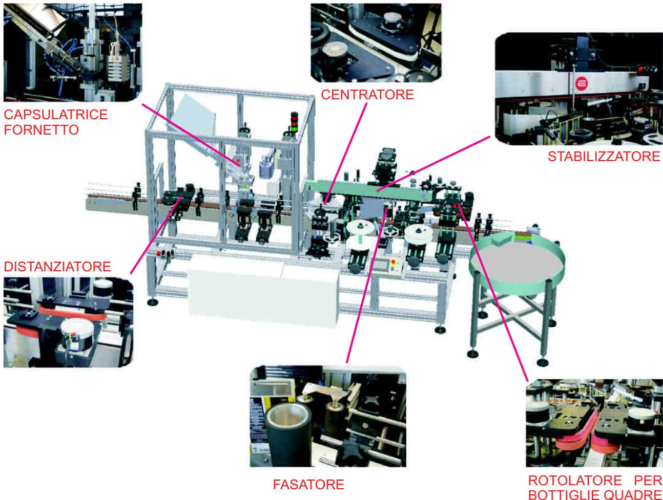
Sistema composto da capsulatrice automatica abbinata a linea etichettatrice Saturno per l'applicazione di 2 (fronte/retro) a 3 (fronte/retro e collarino) etichette su bottiglie cilindriche o quadre di olio, vino e aceto.
