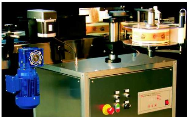
Linea compatta per etichettatura in automatico di prodotti cilindrici, composta da nastro trasportatore a velocità variabile 0-25mt/min con basamento in acciaio e alluminio.
