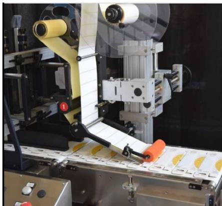
Sistema automatico di raccolta per astucci piani, buste, cartoncini con magazzino di carico regolabile a dimensione e spessore prodotto. Struttura in acciaio e alluminio. gestione e controllo tramite PLC e interfaccia operatore tramite Touch-screen 7" a colori. Tutti i motori sono sincronizzati e controllati dal pannello operatore
