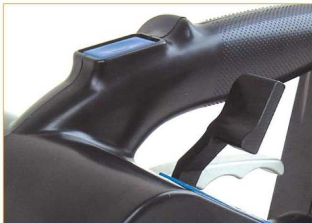
Impugnatura ergonomica - Nuove leve per azionamento saldatura e apertura macchina
