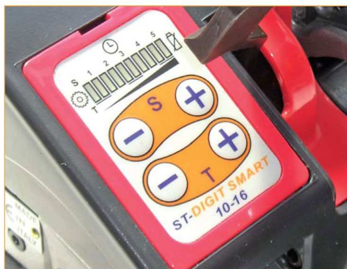
Nuovo sistema tastiera digitale per variare tensione e tempo di saldatura
