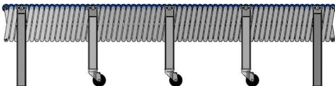
Monta cinque coppie di sostegni di cui i tre centrali con ruota senza freno.
