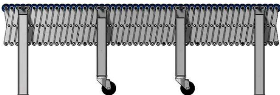
Monta quattro coppie di sostegni di cui i due centrali con ruota senza freno.
